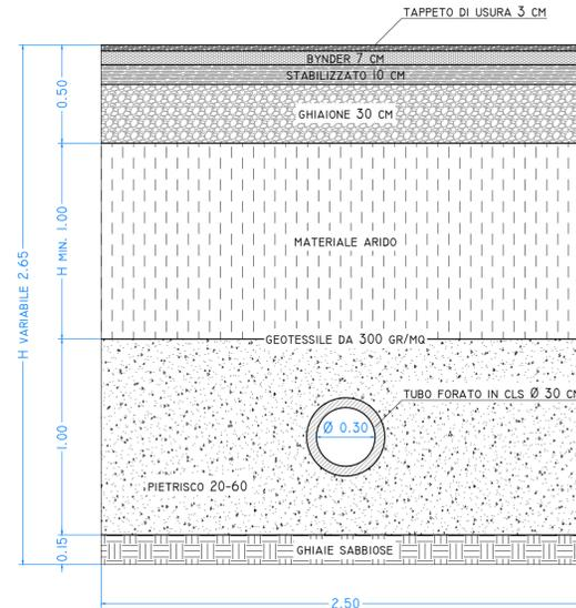
PARTICOLARE POZZETTO TRINCEA DI DRENAGGIO IN SCALA 1: 20
