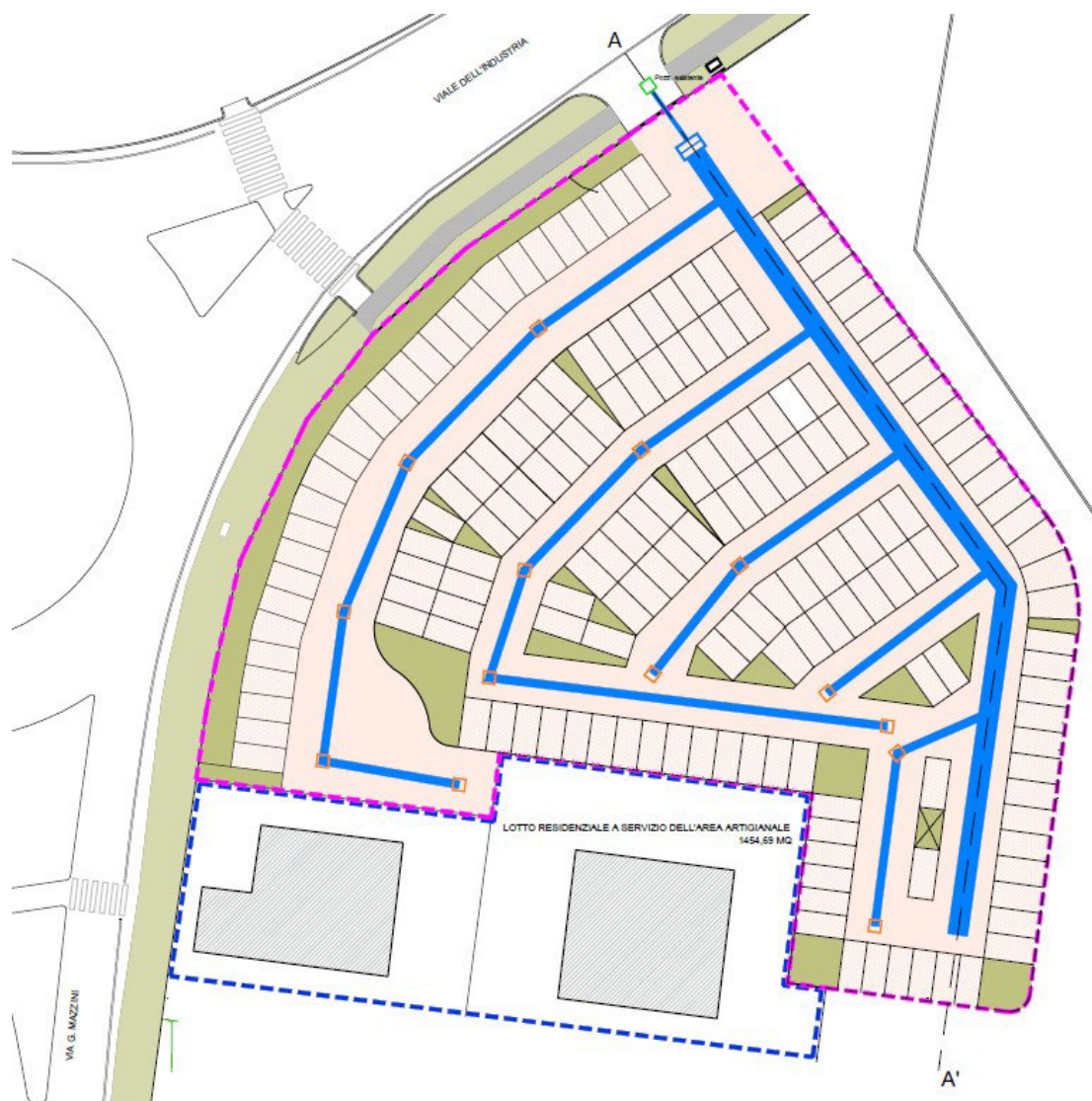
Figura 5.12: Planimetria idraulica delle casse di laminazione
