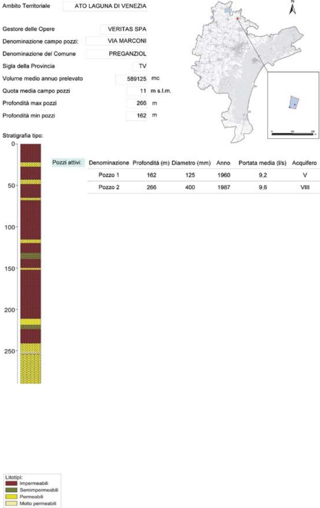
Figura 5.5 - Scheda di sintesi del campo pozzi di Via Marconi.
