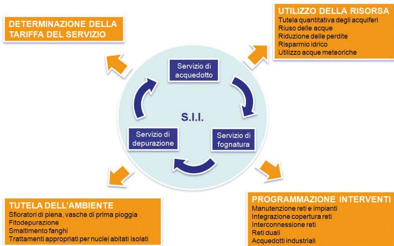
Figura 2.1 - Schema delle attività insite nella pianificazione del Servizio Idrico Integrato.
