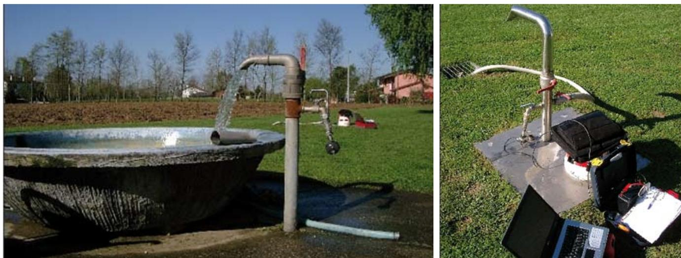
**Figura 4.5** - Esempio di due pozzi utilizzati per la prova in configurazione pozzo-piezometro (prova di falda). Nell'immagine a destra si può vedere la strumentazione di monitoraggio utilizzata nel piezometro di osservazione.
