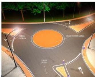
In area urbana vengono generalmente progettate rotatorie con raggio esterno massimo di 12m, con isola centrale sormontabile.
