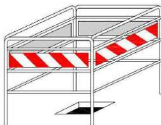
Nel caso di presenza di **pozzetti aperti o di scavi di limitata superficie**, come ad es. scavi per la posa di pozzetti fognature, di plinti di fondazione, ecc... , le aperture di detti scavi/buche **aperti anche solo per un tempo brevissimo**, devono essere correttamente segnalate e circondate da idoneo parapetto e da tavola fermapiede oppure devono essere coperte con tavolato solidamente fissato e di resistenza non inferiore a quella del piano di calpestio dei ponti di servizio.
