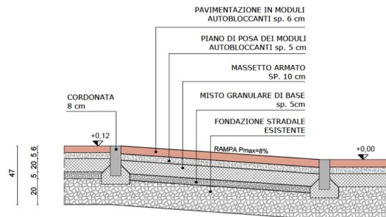
**P4 - SEZIONE PONTICELLO DI ATTRAVERSAMENTO DEL LIONA**
