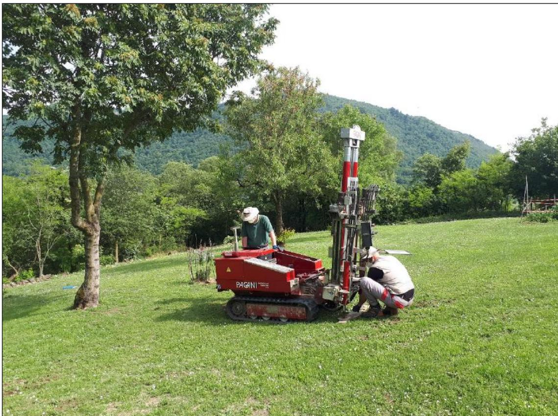
Fig. 16 Penetrometro su prova DPSH1
