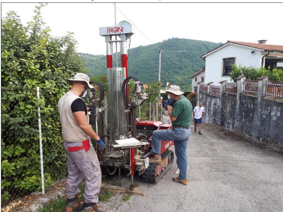
Fig. 19 Penetrometro su prova DPSH4
