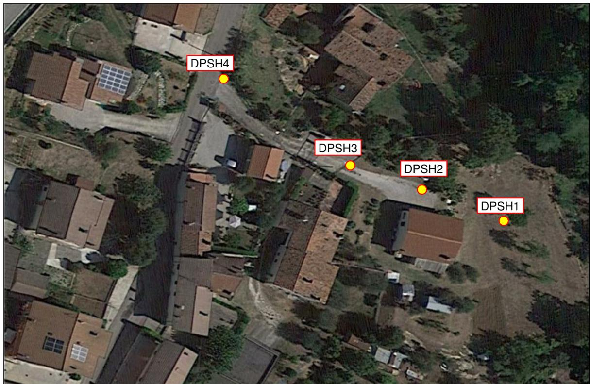
*Fig. 15 Ubicazione prove penetrometriche*
