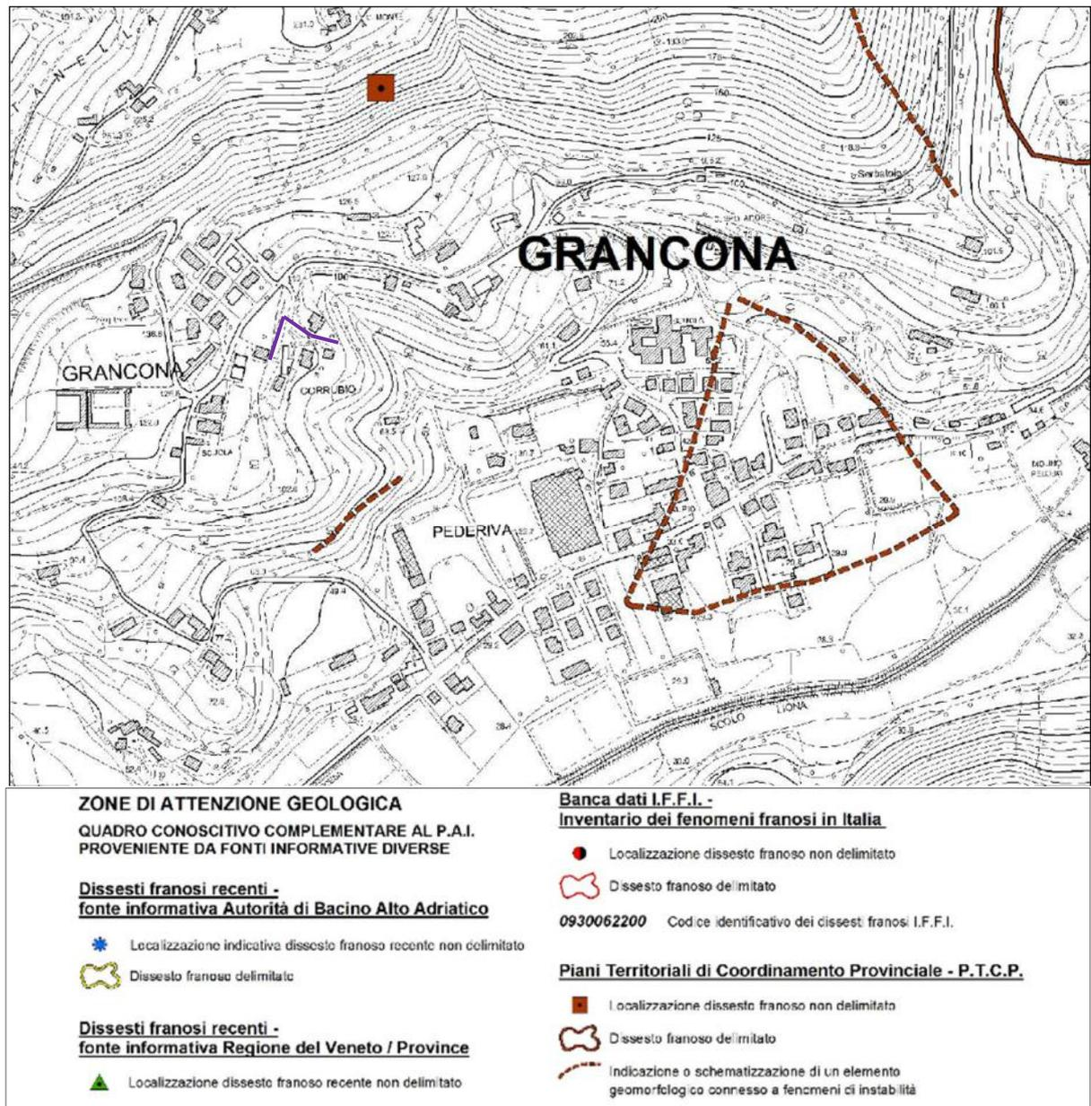
Fig. 9 Estratto Carta delle Pericolosità geologica del PAI con indicazione approssimativa del tracciato in progetto
