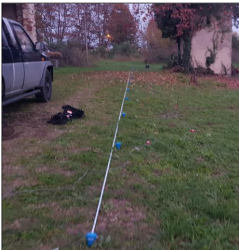
Catena sismica a 16 geofoni (geofoni a 4.5 Hz ad asse verticale uniti in array lineari o bidimensionali totalmente digitali - SoilSpy Rosina della ditta MoHo Srl).
