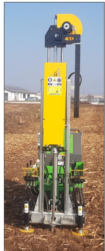
Georesistivimetro Abem mod. Terrameter SAS 1000 a 64 elettrodi.
