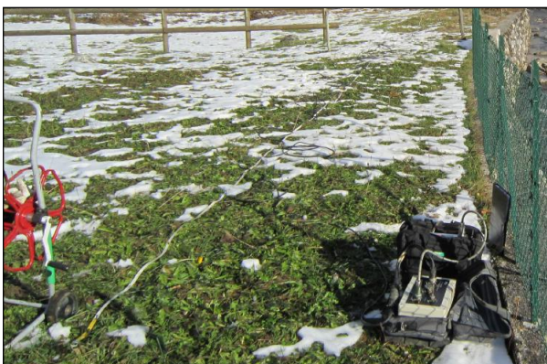
Georesistivimetro Abem mod. Terrameter SAS 1000 a 64 elettrodi.
