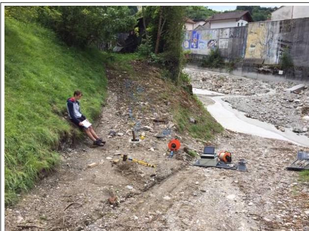
Profilo sismico down-hole1 (DH1) su sond. S1
