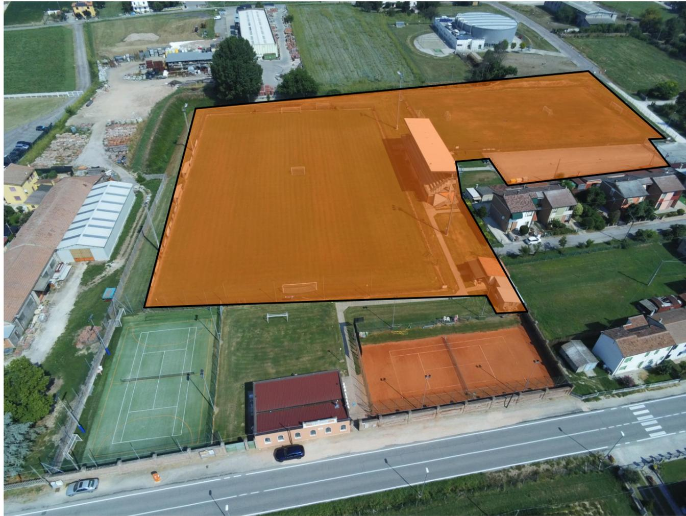
La zona colorata di arancio individua la porzione di struttura allacciata al medesimo contatore di energia elettrica, impianto fotovoltaico con accumulo in progetto e gestita dal medesimo **IMPIANTO DOMOTICO**
